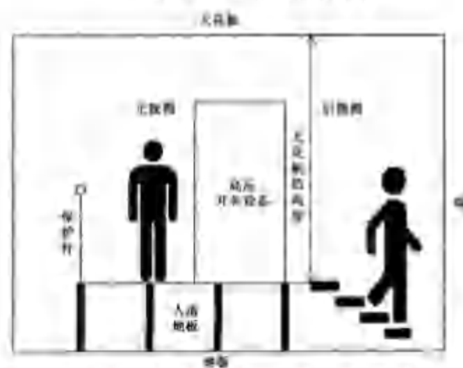
c) 在人造地板上安装的开关设备,且正面和后面的地板水平不同
