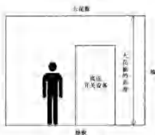
a) 在地板上安装的开关设备
